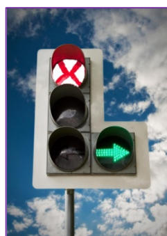
F 41 - 43. Voorbeeld hoe een verkeerslicht in eenduidigheid kan toenemen door naast kleur een (witte) vorm toe te passen.
