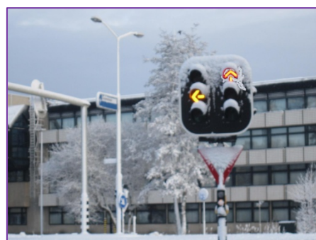
F 41 - 43. Voorbeeld hoe een verkeerslicht in eenduidigheid kan toenemen door naast kleur een (witte) vorm toe te passen.
